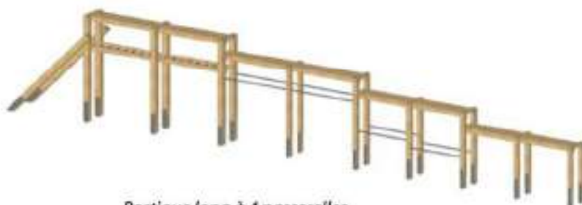
Portique long à 4 passerelles
